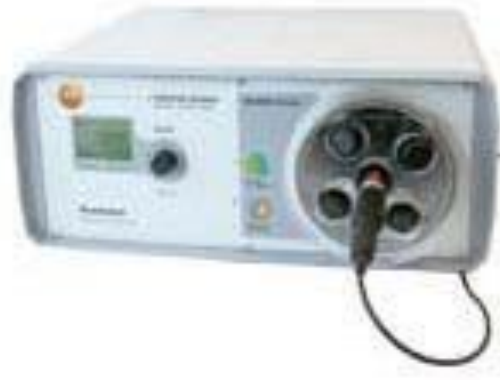
Şekil 2. Nem kalibrasyon cihazı TESTO HUMINATOR
