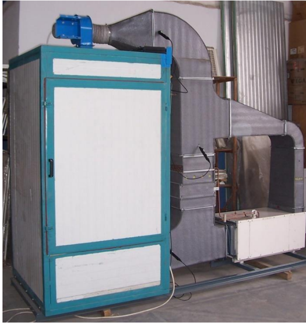
Şekil 2. Isı pompalı kurutucunun deney düzeneği
